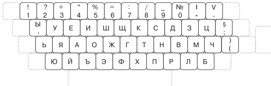
Фигура 5 Схема на клавиатурна подредба за пишещи машини с 46 буквено-цифрови клавиша
